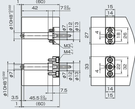
※1 压板和安装面上可能会出现0.42mm的缝隙, 但使用上没有问题。
