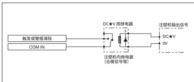
输出信号的电路规格（警报输出）
