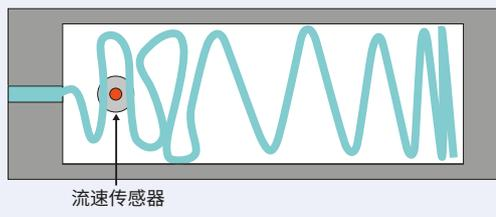
发生喷射时，波形会明显发生变化。
