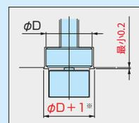
※请在考虑到顶针和紧固螺栓避位孔的直径的基础上决定。
