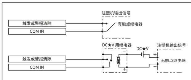
例 2：要连接的注塑机的输出为“电压输出”时
