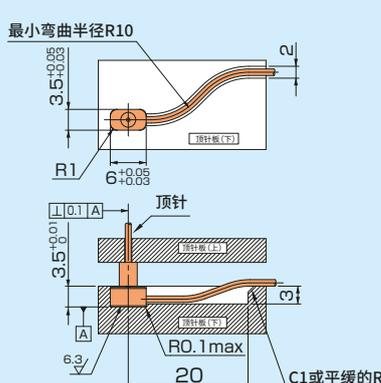
注意1: 设置时,确保传感器的突起侧与顶针挂台部位的后面接触。
