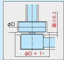
※ 请在考虑到顶针和紧固螺栓避位孔的直径的基础上决定。
