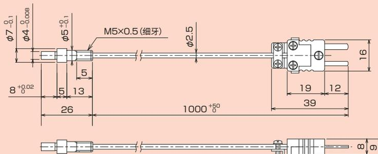
※ 请使用模具表面温度传感器用转换线，通过Y端子与测量仪器连接。
